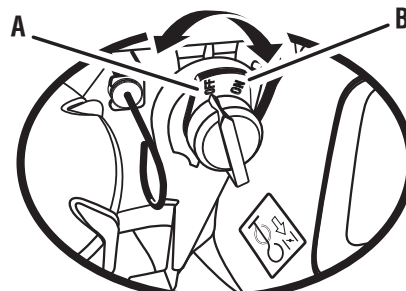
A - OFF (arrêt, apagado) B - ON (marche, encendido)
